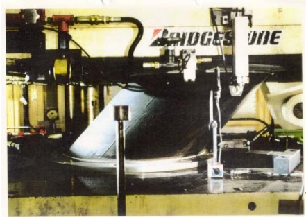
積層ゴムの変形(実験時)
